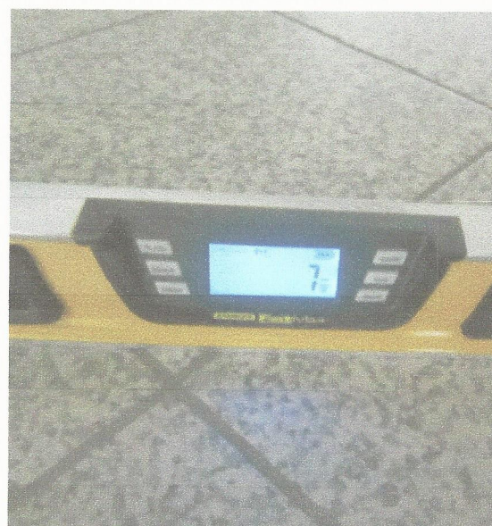
Rys. 29. Nachylenie badanych stropów Wydziału Prawa i Administracji UŚ
